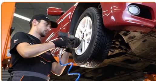
**36** Baje el automóvil y, manteniendo el orden cruzado, apriete los pernos de fijación de las ruedas. Utilice una llave dinamométrica. Apriételo a un par de 120 Nm.
