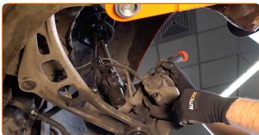
**9** Destornille la fijación del cáliper de freno. Use Vaso HEX No. H7. Utilice una llave de trinquete.
