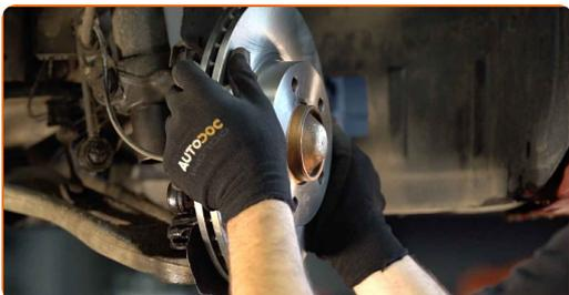
**21** Apriete la fijación del disco de freno. Utilice Torx T30. Utilice una llave dinamométrica. Apriételo a un par de 16 Nm.
