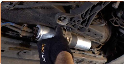
**16** Apriete la fijación del filtro de combustible. Use un vaso de impacto del n.º 10. Utilice una llave de trinquete.
