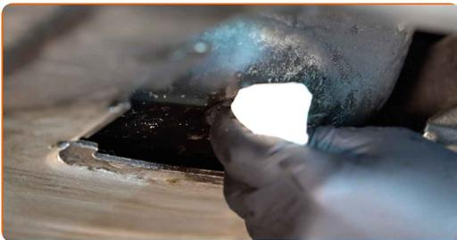
22 Atornille en el nuevo tapón de drenaje y apriételo. Use un vaso de impacto del n.º 17. Utilice una llave dinamométrica. Apriételo a un par de 25 Nm.
