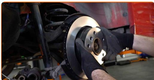
**23** Apriete la fijación del disco de freno. Utilice Torx T30. Utilice una llave dinamométrica. Apriételo a un par de 16 Nm.
