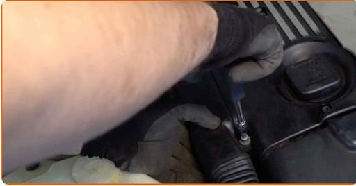
**21** Apriete la sujeción inferior del soporte del motor. Use un vaso de impacto del n.º 16. Utilice una llave dinamométrica. Apriételo a un par de 65 Nm.
