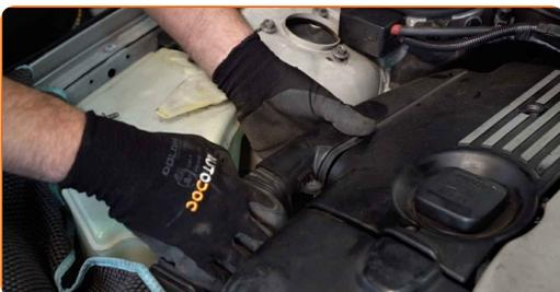
**20** Asegure la sujeción del conducto de admisión de aire. Use Vaso HEX No. H5. Utilice una llave de trinquete.
