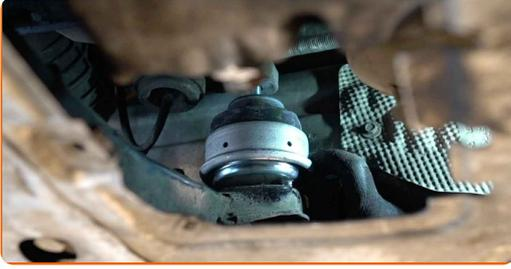
**17** Retire el soporte por debajo del motor.
