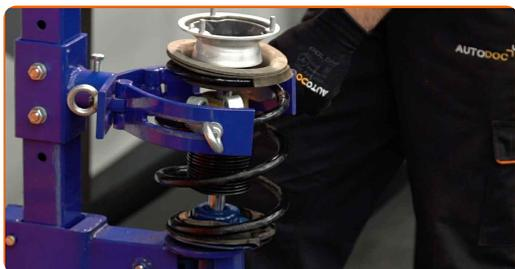
43 Retire el puntal amortiguador que está montado.
