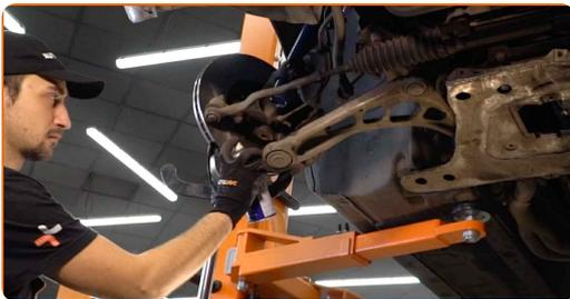
53 Trate las sujeciones que conectan el brazo de control a la mangueta de dirección. Use grasa de cobre.
