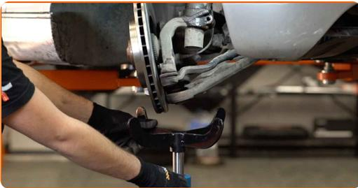
21 Suelte la sujeción inferior que conecta el puntal amortiguador a la mangueta de dirección. Utilice un vaso de impacto especial para extraer el amortiguador.
