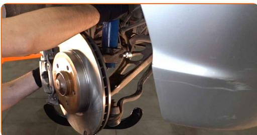
**50** Apriete las sujeciones inferiores que conectan el amortiguador con la mangueta de dirección. Use un vaso de impacto del n.º 18. Utilice una llave dinamométrica. Apriételo a un par de 80 Nm.
