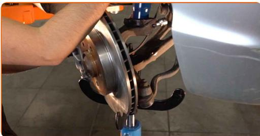
**49** Fije la pata amortiguadora en el muñón de dirección.
