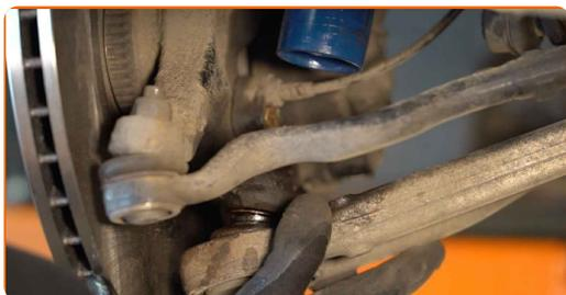
55 Instale las sujeciones del brazo de control.
