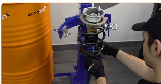
44 Instale la tapa del soporte del amortiguador.
