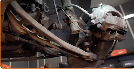
20 Sostenga el muñón de dirección. Utilice un gato de transmisión hidráulica.
