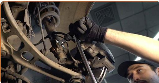
15 Destornille la fijación del soporte esférico del muñón de dirección. Usa una llave mixta del n.º 19.
