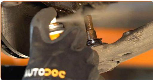
54 Conecte la palanca inferior al muñón de dirección.
