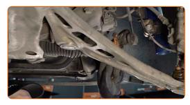
Desatornille la sujeción que conecta la bieleta de barra estabilizadora al amortiguador. Use Vaso HEX No. H7. Usa una llave mixta del n.º 17. Utilice una llave de trinquete.
