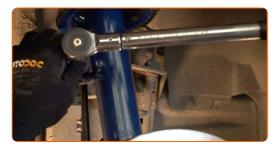
Apriete la sujeción que conecta la bieleta a la barra estabilizadora. Use un vaso de impacto del n.º 17. Usa una llave mixta del n.º 17. Utilice una llave dinamométrica. Apriételo a un par de 55 Nm.
