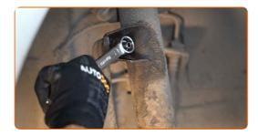
Desatornille la sujeción que conecta la bieleta a la barra estabilizadora. Use Vaso HEX No. H7. Usa una llave 10 mixta del n.º 17. Utilice una llave de trinquete.
