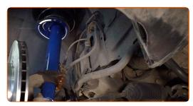
Apriete la sujeción que conecta la bieleta de barra estabilizadora al amortiguador. Use un vaso de impacto del n.º 17. Usa una llave mixta del n.º 17. Utilice una llave dinamométrica. Apriételo a un par de 55 Nm.
