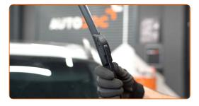
Presione el clip de fijación. Retire la escobilla del brazo del limpiaparabrisas.
