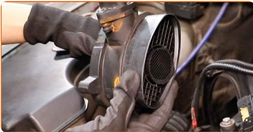
22 Instale un nuevo sensor de flujo de masa de aire.
