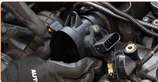
23 Apriete las sujeciones del sensor MAF. Utilice Torx T25. Utilice una llave dinamométrica. Apriételo a un par de 8 Nm.
