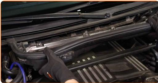
**12** Desatornille la sujeción de la cubierta del motor. Use Vaso HEX No. H5. Utilice una llave de trinquete.
