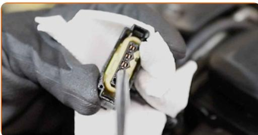
**28** Una el conector del sensor de flujo de masa de aire.
