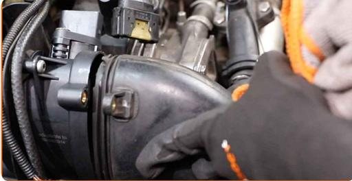
**26** Apriete las sujeciones que conectan el conducto de aire con el sensor MAF. Use Vaso HEX No. H5. Utilice una llave dinamométrica. Apriételo a un par de 5 Nm.
