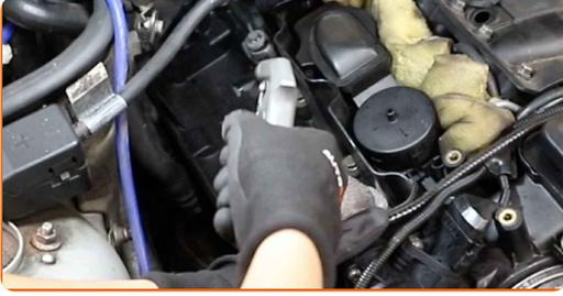
30 Inserte el cartucho del filtro en la carcasa del filtro. Asegúrese de que el borde del filtro encaje firmemente en la carcasa.
