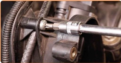
21 Retire el sensor de flujo de masa de aire.
