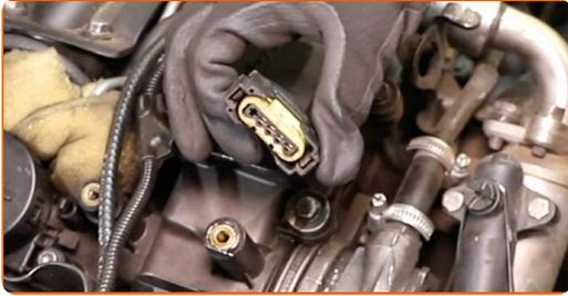
20 Desenrosque las sujeciones del sensor MAF. Utilice Torx T25. Utilice una llave de trinquete.
