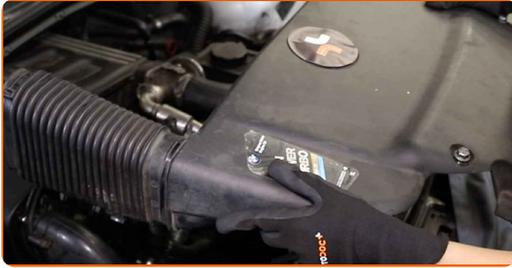
7 Suelte los clips de la cubierta del filtro del habitáculo.
