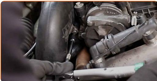
**27** Trate el conector del sensor de flujo de masa de aire. Utilice grasa dieléctrica.
