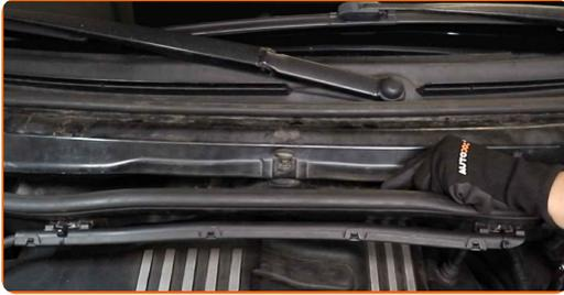
38 Conecte los clips de la cubierta del filtro del habitáculo.
