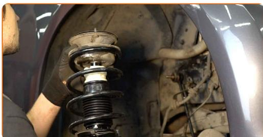
**46** Atornillen la fijación superior de la cazoleta de la pata amortiguadora. Use un vaso de impacto del n.º 13. No lo apriete.
