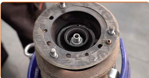
**31** Trate la varilla del amortiguador. Use un cepillo de alambre. Use el aerosol WD-40.
