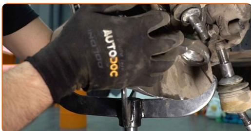
**50** Instale el perno de sujeción.
