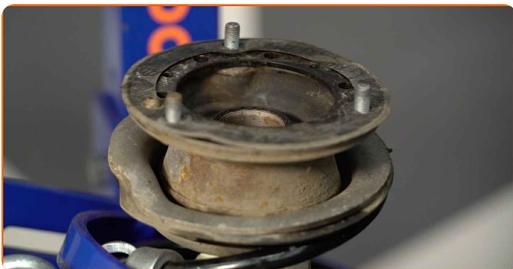
**41** Apriete la tuerca de la varilla de la pata amortiguadora. Use un vaso de impacto del n.º 21. Use Vaso HEX No. H6. Utilice una llave de trinquete. Utilice una llave dinamométrica. Apriételo a un par de 64 Nm.
