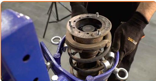
**30** Quite la tapa del soporte del amortiguador. Use una palanca.
