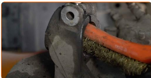
**48** Fije la pata amortiguadora en el muñón de dirección.
