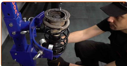
**44** Retire el puntal amortiguador que está montado.
