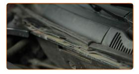
Atornille las sujeciones de la rejilla de la capucha del limpiaparabrisas situada en el lado derecho. Utilice Torx T30. Utilice una llave de trinquete.
