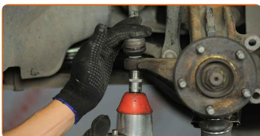
**49** Trate la sujeción que conecta el extremo de la barra de acoplamiento a la mangueta de dirección. Use grasa de cobre.
