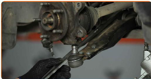
**22** Separe el eje de transmisión de la mangueta de dirección.
