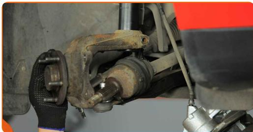
**26** Desconecte el muñón de dirección de la pata amortiguadora. Utilice un martillo.
