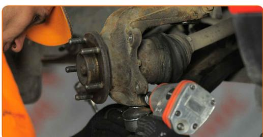
**44** Conecte el conector del sensor ABS.
