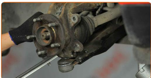
**42** Instale el perno de sujeción. Utilice un martillo.
