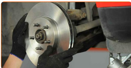
**52** Limpie los asientos de montaje de la pinza de freno y su soporte. Use un cepillo de alambre. Use el aerosol WD-40.
