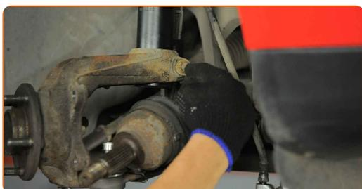
**24** Desatornille la sujeción inferior que conecta el puntal amortiguador a la mangueta de dirección. Use un vaso de impacto del n.º 15. Utilice una llave de trinquete.
