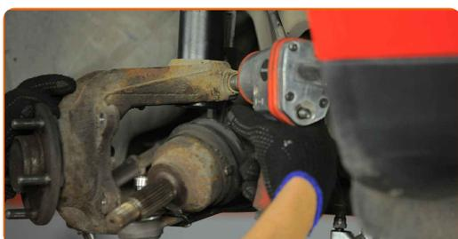
**25** Retire el perno de sujeción.
