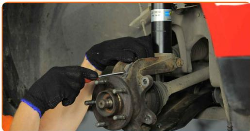
**12** Limpie el tornillo de sujeción del eje de transmisión. Use un cepillo de alambre. Use el aerosol WD-40.
