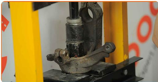
**31** Limpie el asiento de montaje del cojinete del cubo (buje). Use un cepillo de alambre. Use el aerosol WD-40.
