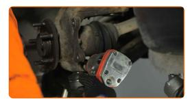
Apriete las sujeciones inferiores que conectan el amortiguador con la mangueta de dirección. Use un vaso de impacto del n.º 15. Utilice una llave dinamométrica. Apriételo a un par de 83 Nm.
