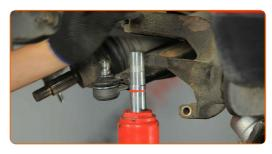
Suelte la sujeción inferior que conecta el puntal amortiguador a la mangueta de dirección. Utilice un cincel de metal plano. Utilice un martillo.
