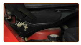
Limpie las sujeciones del soporte superior del puntal amortiguador. Use un cepillo de alambre. Use el aerosol WD-40.
