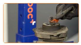
Destornille la tuerca de la varilla de la pata amortiguadora. Utilice un destornillador plano. Use un vaso de impacto del n.º 18. Utilice una llave de trinquete.
