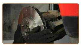
Limpie los asientos de montaje de la pinza de freno y su soporte. Use un cepillo de alambre. Use el aerosol WD-40.
