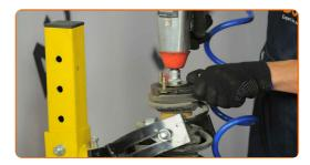
Quite la cazoleta, el guardapolvos y el tope del amortiguador. Utilice un destornillador plano.
