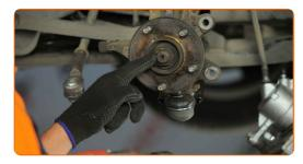
Desenrosque la fijación que conecta el eje de transmisión al cubo de la rueda. Use un vaso de impacto del n.º 32. Utilice una llave de trinquete.
