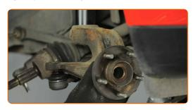
67 Sostenga el muñón de dirección. Utilice un gato de transmisión hidráulica.
