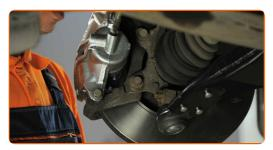
Destornille la fijación de la pinza del cáliper de freno. Use un vaso de impacto del n.º 17. Utilice una llave de trinquete.
