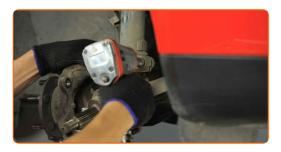
Retire el perno de sujeción.
