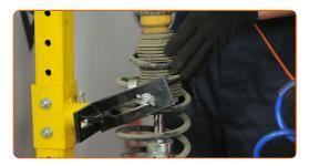
Instale el soporte de montaje superior del puntal y el cojinete del soporte de montaje del puntal. Use Vaso HEX No. H5.
