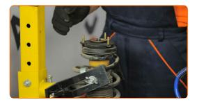
Apriete la tuerca de la varilla de la pata amortiguadora. Utilice un destornillador plano. Use un vaso de impacto del n.º 18. Utilice una llave dinamométrica. Apriételo a un par de 58 Nm.
