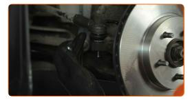
Apriete la tuerca de fijación que conecta el extremo de la barra de acoplamiento a la mangueta de dirección. Use un vaso de impacto del n.º 17. Utilice una llave dinamométrica. Apriételo a un par de 40 Nm.
