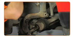
Desconecte el muñón de dirección de la pata amortiguadora. Utilice un martillo.
