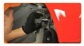
Desconecte el soporte de fijación del latiguillo de freno.
