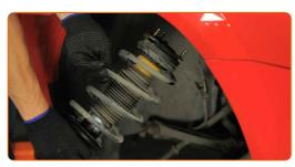
Atornillen la fijación superior de la cazoleta de la pata amortiguadora.
