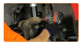
78 Trate las sujeciones del amortiguador. Use grasa de cobre.
