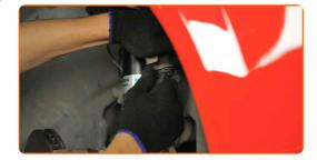
Trate la superficie donde el disco del freno entra en contacto con la llanta de la rueda. Use grasa de cobre.
