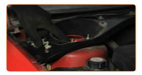
Destornille la fijación superior de la cazoleta de la pata amortiguadora. Use un vaso de impacto del n.º 13. Utilice una llave de trinquete.
