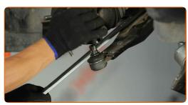
75 Instale el perno de sujeción. Utilice un martillo.
