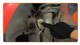
Desatornille la sujeción que conecta la bieleta de barra estabilizadora al amortiguador. Usa una llave mixta del n.º 17. Use Vaso HEX No. H5. Utilice una llave de trinquete.
