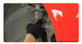
Destornille la fijación del soporte del latiguillo de freno de la pata amortiguadora. Use un vaso de impacto del n.º 15. Utilice una llave de trinquete.
