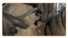
Destornille la fijación del cáliper de freno. Use Vaso HEX No. H7. Utilice una llave de trinquete.
