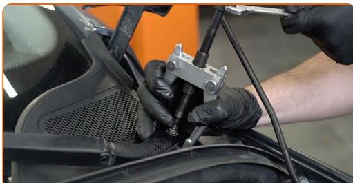
**6** Desatornille las sujeciones del depósito de líquido de frenos. Utilice Torx T20. Utilice una llave de trinquete.
