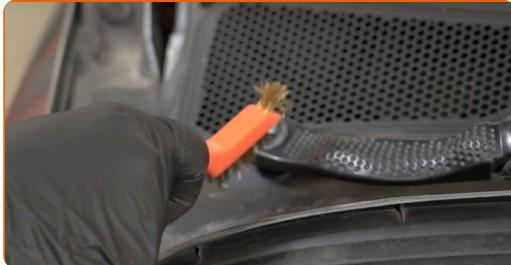
**4** Desenrosque las fijaciones de los brazos del limpiaparabrisas. Use un vaso de impacto del n.º 16. Utilice una llave de trinquete.
