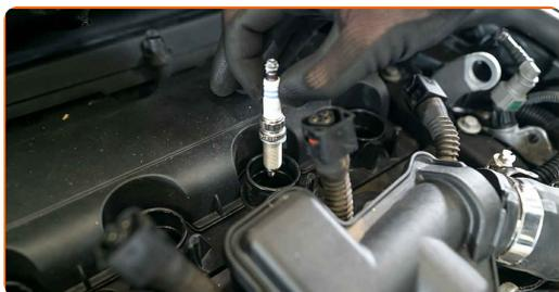
**10** Atornille las bujías nuevas y apriételas. Use el vaso para bujía de 12 puntos # 14. Utilice una llave dinamométrica. Apriételo a un par de 23 Nm.
