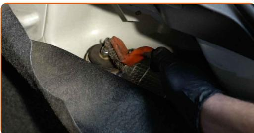
**6** Destornille la fijación superior del amortiguador. Utilice un vaso para amortiguador DDNº6 Use un vaso de impacto del n.º 16. Utilice una llave de trinquete.
