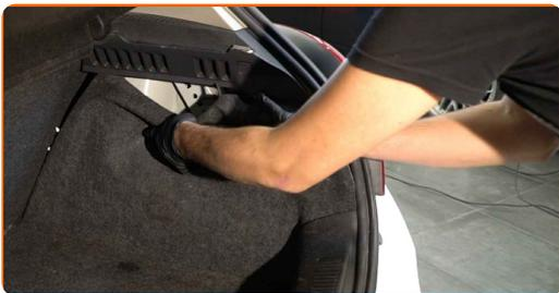
**5** Limpie las sujeciones del amortiguador. Use un cepillo de alambre. Use el aerosol WD-40.
