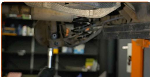
**20** Instale el perno de sujeción.
