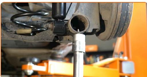
**26** Instale el perno de sujeción.
