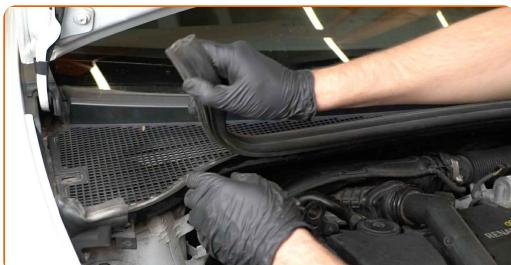
**8** Retire los clips de la rejilla del capó. Utilice una herramienta de extracción de clips.
