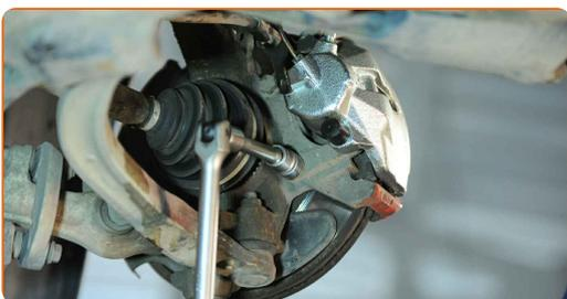
**9** Desconecten el punto de separación eléctrico del sensor ABS. Utilice un destornillador plano.
