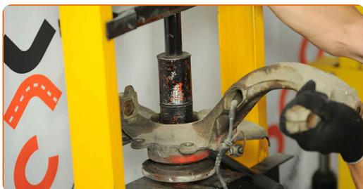
**33** Instale el muñón de dirección una vez ensamblado con el cubo.
