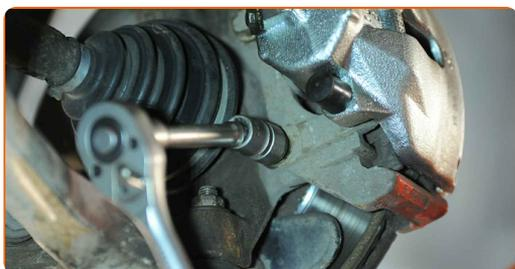
**50** Conecte la fijación del cable del captador ABS.
