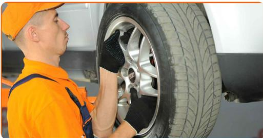
**6** Destornille la fijación del cubo de la rueda. Use un vaso de impacto del n.º 27.
