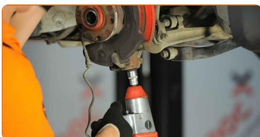
**36** Apriete la fijación del soporte esférico. Use un vaso de impacto del n.º 18. Utilice una llave dinamométrica. Apriételo a un par de 100 Nm.
