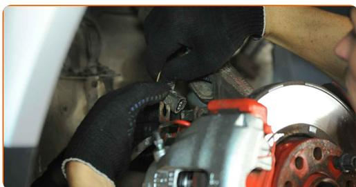
**51** Conecte el captador de desgaste de las pastillas de freno.
