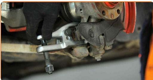
**17** Destornille la fijación del soporte esférico del muñón de dirección. Use un vaso de impacto del n.º 18. Utilice una llave de trinquete.
