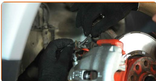
**52** Trate la superficie donde el disco del freno entra en contacto con la llanta de la rueda. Use grasa de cobre.
