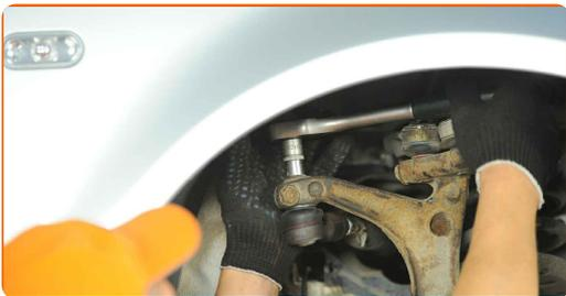
**41** Apriete la tuerca de fijación que conecta el extremo de la barra de acoplamiento a la mangueta de dirección. Use un vaso de impacto del n.º 13. Utilice una llave dinamométrica. Apriételo a un par de 7 Nm.
