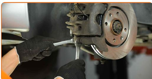
**23** Conecte el cable sensor de desgaste de las pastillas de freno.
