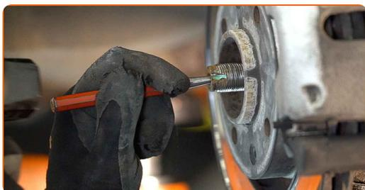
**22** Limpie la sujeción inferior que conecta el puntal de suspensión con la mangueta de dirección. Use un cepillo de alambre. Use el aerosol WD-40.
