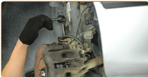
**11** Limpie las sujeciones que conectan el extremo de la barra de acoplamiento con la mangueta de dirección. Use un cepillo de alambre. Use el aerosol WD-40.
