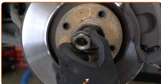
**21** Separe el eje de transmisión de la mangueta de dirección. Use un punzón. Utilice un martillo.
