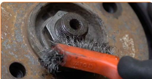
**19** Destornille la fijación del cubo de la rueda. Use un vaso de impacto del n.º 36. Utilice una llave de trinquete.
