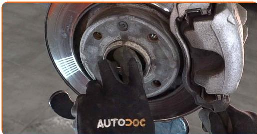
**68** Apriete la sujeción del cubo. Use un vaso de impacto del n.º 36. Utilice una llave dinamométrica. Apriételo a un par de 325 Nm.
