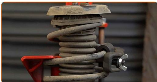
**35** Trate la varilla del amortiguador. Use un cepillo de alambre. Use el aerosol WD-40.
