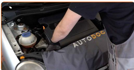
**3** Separe el manguito de ventilación del cárter de la cubierta del motor en la izquierda.
