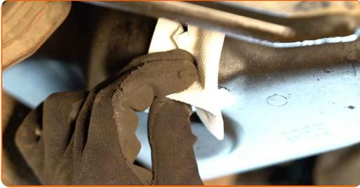
15 Atornille en el nuevo tapón de drenaje y apriételo. Use un vaso de impacto del n.º 19. Utilice una llave dinamométrica. Apriételo a un par de 30 Nm.
