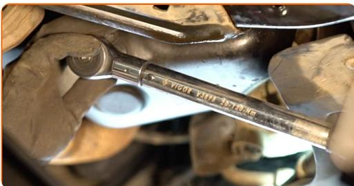
16 Limpie el área del orificio de drenaje de la bandeja de aceite. Utilice un spray de limpieza multiuso.
