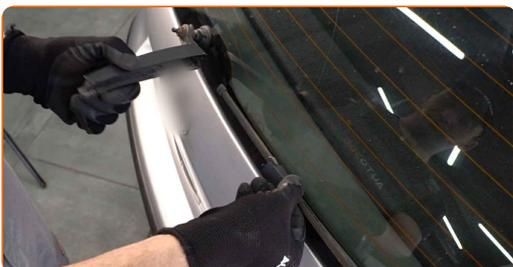
**3** Presione el clip de fijación. Retire la escobilla del brazo del limpiaparabrisas.
