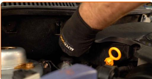
**4** Quite la tapa decorativa del motor. El cuerpo del filtro de aire está integrado en la tapa del motor.
