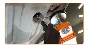
Retire la cubierta protectora de plástico de la carrocería.
