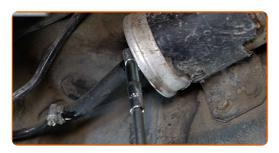
Desenrosque el soporte del filtro de combustible. Use un vaso de impacto del n.º 10. Utilice una llave de trinquete.
