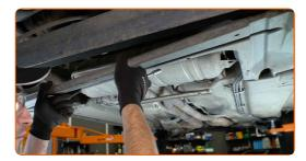
Atornille las sujeciones de la cubierta protectora de plástico de la carrocería. Use un vaso de impacto del n.º 10. Utilice una llave de trinquete.
