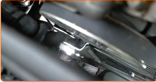
**12** Coloque la correa serpentina en la polea del cigüeñal.
