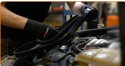
**11** Tire hacia un lado la polea tensora de la correa acanalada en V. Usa una llave mixta del n.º 17.
