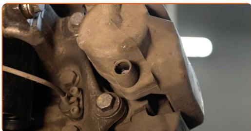
**15** Destornille la fijación del cáliper de freno. Use Vaso HEX No. H7. Utilice una llave de trinquete.
