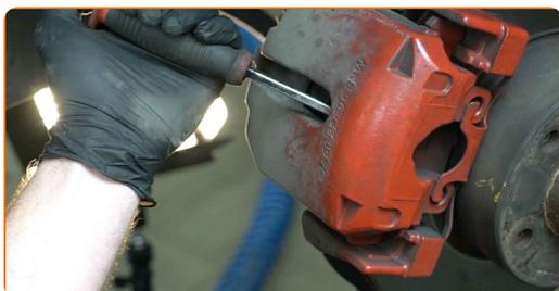
**17** Separe el muelle de retención de la pinza de freno. Use una palanca.
