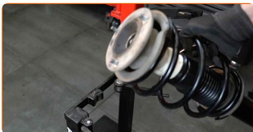
**56** Instale la pata amortiguadora en el arco de la rueda.
