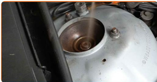
**97** Instale la tapa del soporte del amortiguador.
