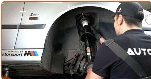
**57** Atornillen la fijación superior de la cazoleta de la pata amortiguadora. No lo apriete.
