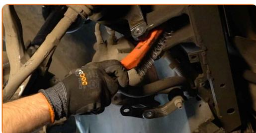
**64** Instale la sujeción trasera del brazo de control.
