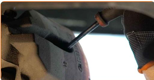
**14** Destornille la fijación de la pinza del cáliper de freno. Use un vaso de impacto del n.º 18. Utilice una llave giramachos.
