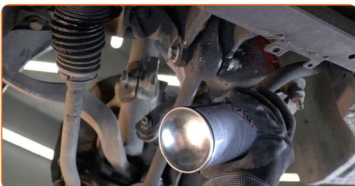
**27** Retire la cubierta del brazo de control.
