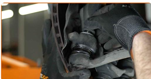
**70** Instale el soporte de montaje del amortiguador usando el orificio central como guía.
