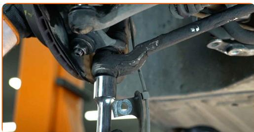
**68** Conecte la punta de la barra de dirección al muñón de dirección.
