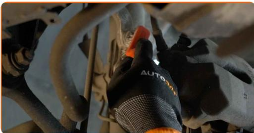
**12** Limpie las sujeciones del soporte de la pinza del freno. Use un cepillo de alambre. Use el aerosol WD-40.
