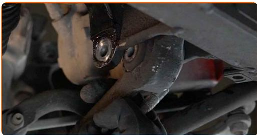
**34** Limpie las sujeciones que conectan el puntal amortiguador a la mangueta de dirección. Use un cepillo de alambre. Use el aerosol WD-40.
