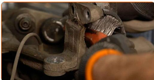
**59** Fije la pata amortiguadora en el muñón de dirección.
