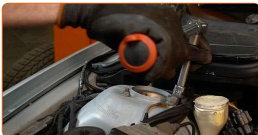
**96** Trate las sujeciones del soporte del amortiguador. Use grasa de cobre.
