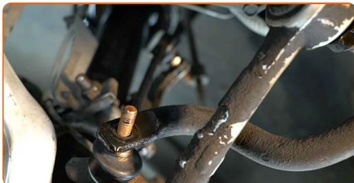
**12** Apriete las fijaciones de la bieleta de la barra estabilizadora. Use una llave mixta del n.º 17. Use un vaso de impacto del n.º 17. Utilice una llave de trinquete.
