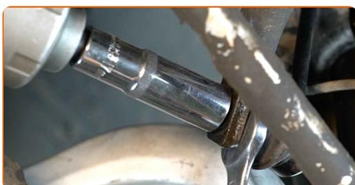
**13** Apriete la sujeción que conecta la bieleta de barra estabilizadora al amortiguador. Use un vaso de impacto del n.º 17. Utilice una llave dinamométrica. Apriételo a un par de 65 Nm.
