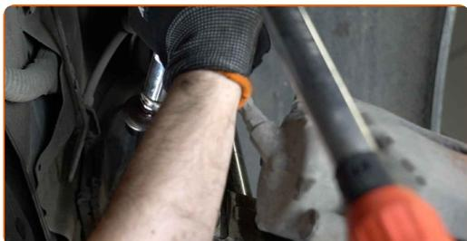
**14** Apriete la sujeción que conecta la bieleta a la barra estabilizadora. Use un vaso de impacto del n.º 17. Utilice una llave dinamométrica. Apriételo a un par de 65 Nm.
