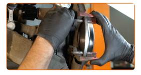
Apriete la fijación de la pinza del cáliper de freno. Use un vaso de impacto del n.º 16. Utilice una llave dinamométrica. Apriételo a un par de 65 Nm.
