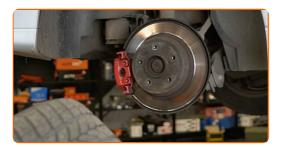
Desconecte el captador de desgaste de las pastillas de freno. Use una palanca.
