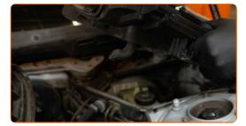
Desatornille el tapón del depósito del líquido de frenos.
