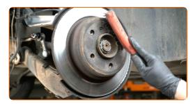
Destornille la fijación del disco de freno. Use Vaso HEX No. H6. Utilice un destornillador de impacto.
