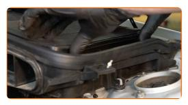
Instale la carcasa del conducto de aire.
