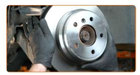
Apriete la fijación del disco de freno. Use Vaso HEX No. H6. Utilice una llave dinamométrica. Apriételo a un par de 16 Nm.
