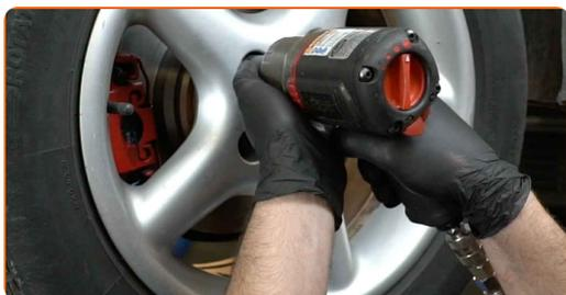
**20** Baje el automóvil y, manteniendo el orden cruzado, apriete los pernos de fijación de las ruedas. Utilice una llave de impacto para llanta # 17. Utilice una llave dinamométrica. Apriételo a un par de 120 Nm.
