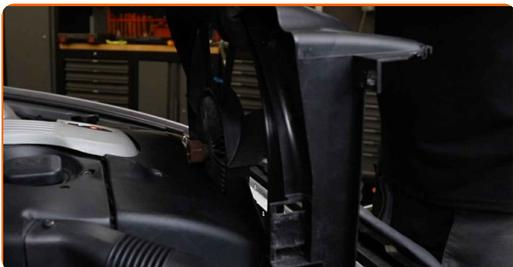
**50** Apriete la sujeción del ventilador de refrigeración. Usa una llave mixta del n.º 32 (2 piezas). Utilice una llave dinamométrica. Apriételo a un par de 33 Nm.
