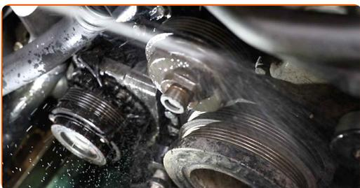
**41** Tire hacia un lado la polea tensora de la correa acanalada en V. Usa una llave mixta del n.º 26.
