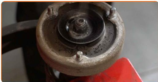
**33** Destornille la tuerca de la varilla de la pata amortiguadora. Use Vaso HEX No. H6. Use un vaso de impacto del n.º 18. Utilice una llave de trinquete.
