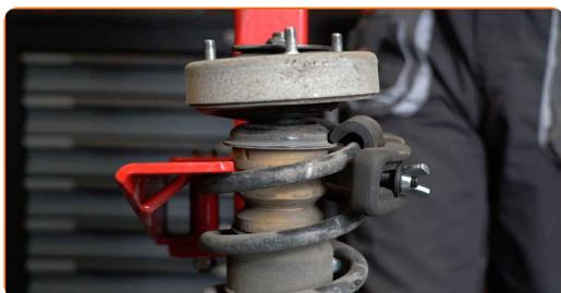
**32** Trate la varilla del amortiguador. Use un cepillo de alambre. Use el aerosol WD-40.
