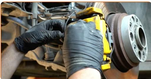
**65** Trate todas las articulaciones del brazo. Trate las sujeciones del amortiguador. Use grasa de cobre.
