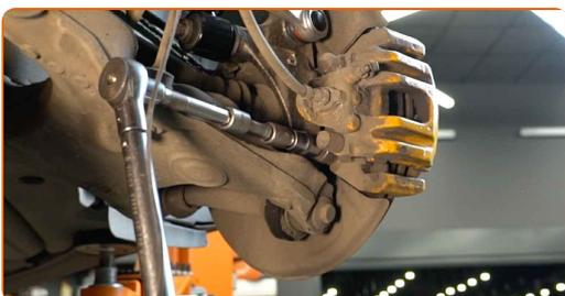
**64** Conecte el captador de desgaste de las pastillas de freno.
