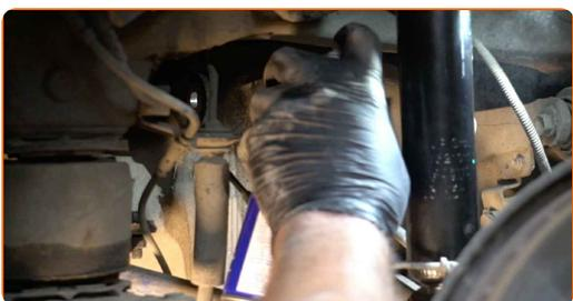
**53** Fije la mangueta de dirección trasera al brazo de control de la suspensión.
