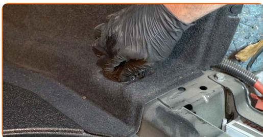
**76** Atornille los sujeciones del revestimiento de la parte delantera del maletero. Utilice Torx T40. Utilice una llave de trinquete.
