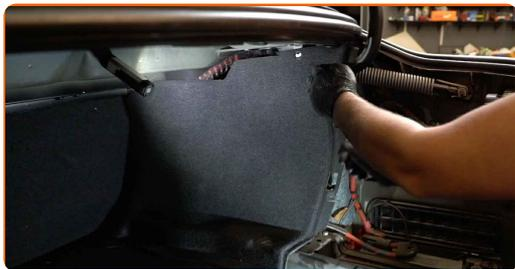
**75** Instale el clip de plástico del revestimiento de la parte delantera del maletero.
