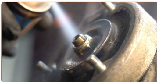
**49** Instale la pata amortiguadora en el arco de la rueda.
