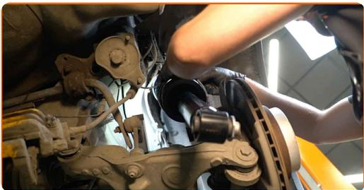
**50** Instale el perno de sujeción.
