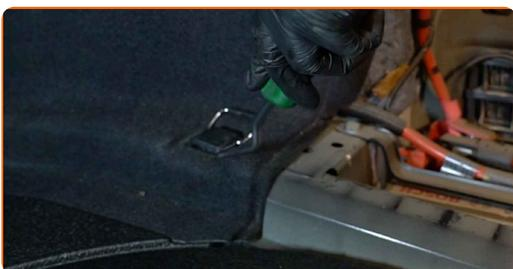
**6** Desatornille las sujeciones del revestimiento (forro) de la parte delantera del maletero. Utilice Torx T40. Utilice una llave de trinquete.
