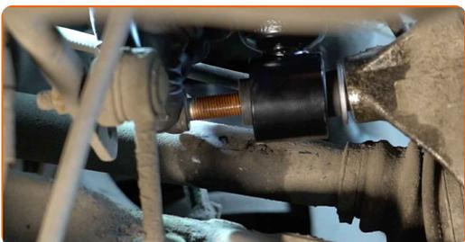
**51** Atornille la sujeción inferior del puntal de suspensión. Usa una llave mixta del n.º 18.
