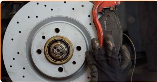
19 Apriete la fijación de la pinza del cáliper de freno. Use un vaso de impacto del n.º 19. Utilice una llave dinamométrica. Apriételo a un par de 95 Nm.
