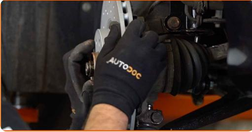
18 Instale el soporte de la pinza del freno junto con las pastillas de freno.
