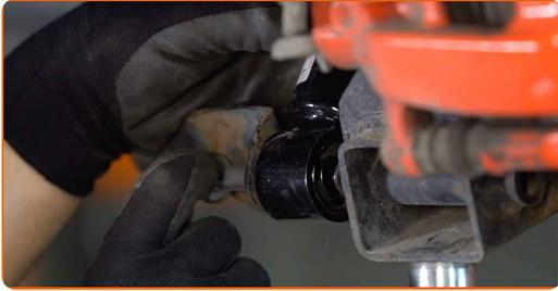
17 Apriete la fijación inferior del amortiguador. Use un vaso de impacto del n.º 19. Utilice una llave dinamométrica. Apriételo a un par de 85 Nm.
