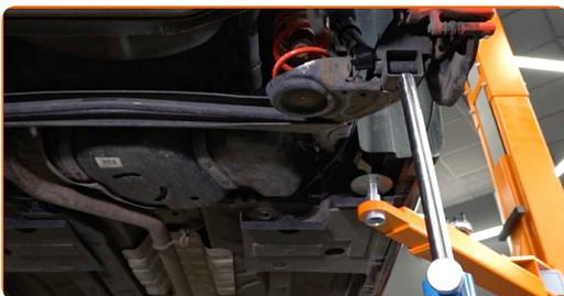
16 Coloque el amortiguador en el arco de la rueda y fíjelo.
