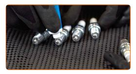
23 Instale las nuevas bujías en sus asientos de montaje.
