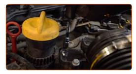
Atornille las sujeciones del manguito de ventilación del cárter. Use un vaso de impacto del n.º 13.
