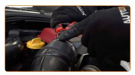
Fije la abrazadera en el manguito de ventilación del cárter. Utilice alicates universales.
