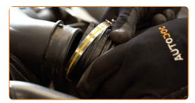
Retire la cubierta del motor ensamblada con la carcasa del filtro de aire.
