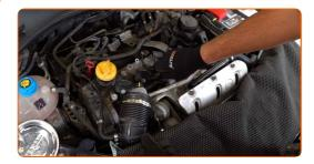
Eleve un poco el cableado de las bobinas del encendido y muévalo a un lado.
