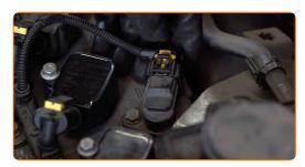
Destornille la sujeción del terminal de puesta a tierra de las bobinas del encendido. Use un vaso de impacto del n.º 10.
