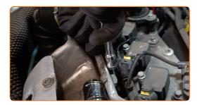
Suelte las sujeciones de plástico de los conectores de la bobina del encendido. Utilice destornilladores planos (2 piezas).
