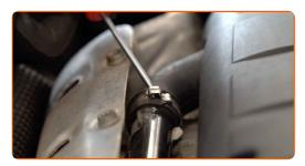
Desatornille la sujeción de la cubierta del motor. Use un vaso de impacto del n.º 10. Utilice una llave de trinquete.
