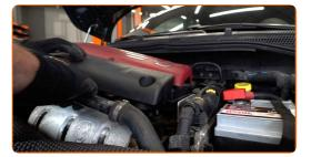
Desconecte la manguera de ventilación del cárter del conducto de aire.
