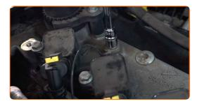
Desconecte los conectores de las bobinas del encendido.
