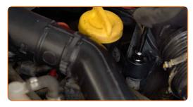
Desconecte el tubo de entrada de aire de la carcasa del filtro de aire.
