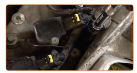
Fije el manguito de ventilación del cárter a la válvula PCV (sistema de ventilación positiva del cárter). Instale la abrazadera del manguito de ventilación del cárter. Utilice alicates universales.
