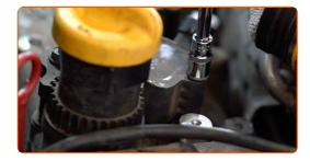
Asegure el cableado de las bobinas del encendido en sus asientos de montaje.
