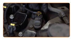
Apriete el terminal de puesta a tierra de las bobinas del encendido. Use un vaso de impacto del n.º 10.
