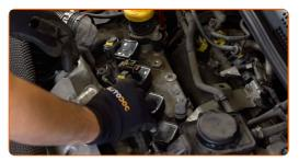
Conecte los conectores de las bobinas del encendido.
