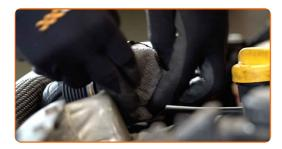
Desatornille las sujeciones del manguito de ventilación del cárter. Use un vaso de impacto del n.º 13. Utilice una llave de trinquete.
