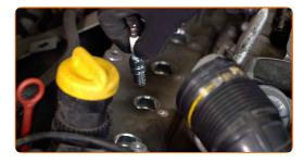
Atornille las buujías nuevas y apriételas. Use el vaso de bujía # 16. Utilice una llave dinamométrica. Apriételo a un par de 24 Nm.
