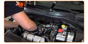
Destornille la atadura de la bobina del encendido. Use un vaso de impacto del n.º 10.
