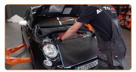
Suelte la abrazadera del manguito de admisión de aire. Utilice un destornillador plano.
