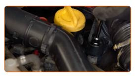
Conecte el tubo de entrada de aire a la carcasa del filtro de aire.
