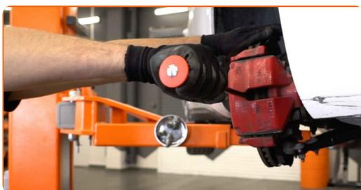
13 Destornille la fijación de la pinza del cáliper de freno. Use un vaso de impacto del n.º 21. Utilice una llave de trinquete. Utilice una llave giramachos.
