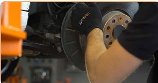
17 Destornille la fijación del cubo de la rueda. Utilice un vaso de 12 puntos # 24.
