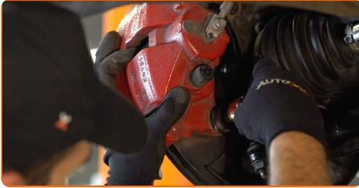
37 Apriete la fijación de la pinza del cáliper de freno. Use un vaso de impacto del n.º 21. Utilice una llave dinamométrica. Apriételo a un par de 190 Nm.
