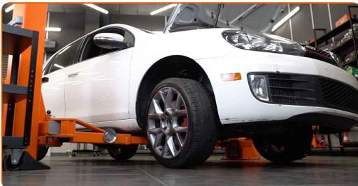
42 Apriete el perno que conecta el eje de transmisión al cubo de la rueda. Utilice un vaso de 12 puntos # 24. Utilice una llave dinamo-métrica. Apriételo a un par de 70 Nm.+90°
