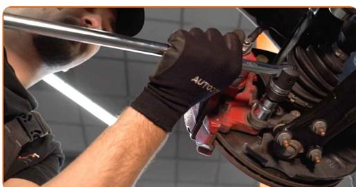
14 Retire la pinza del freno junto con su soporte.
