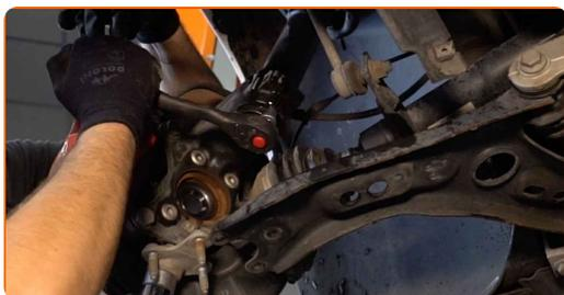
**26** Desconecte el muñón de dirección de la pata amortiguadora. Utilice un cincel de metal plano. Utilice un martillo.
