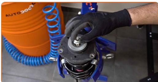
**42** Apriete la tuerca de la varilla de la pata amortiguadora. Use un vaso de impacto del n.º 21. Use Vaso HEX No. H6. Utilice una llave dinamométrica. Apriételo a un par de 60 Nm.
