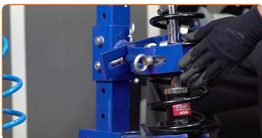
**41** Instale la cazoleta, el guardapolvos y el tope en el amortiguador nuevo.
