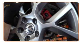
Separe las pastillas de freno. Use una palanca.
