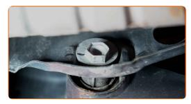
Destornille la fijación de la palanca a la viga. Usa una llave mixta del n.º 18. Use un vaso de impacto del n.º 18. Utilice una llave de trinquete.
