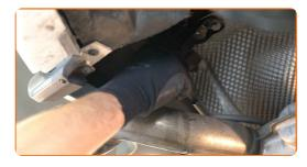
Realice una marca en el travesaño y en el perno de ajuste de la inclinación.
