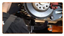
Apriete las sujeciones que conectan el brazo de control a la mangueta trasera. Usa una llave mixta del n.º 18. Use un vaso de impacto del n.º 18. Utilice una llave dinamométrica. Apriételo a un par de 90 Nm.+90°
