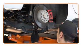
Retire el perno de sujeción.
