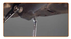
Retire la sujeción del sistema de escape.
