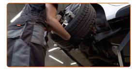
Limpie las sujeciones del brazo de control. Use un cepillo de alambre. Use el aerosol WD-40.
