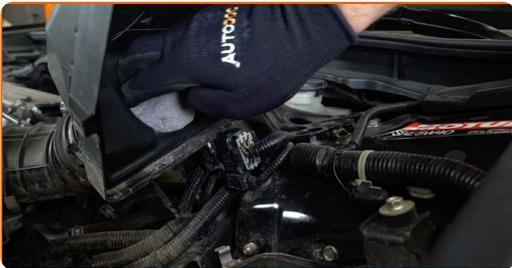
7 Limpie la cubierta y la carcasa del filtro de aire.
