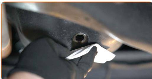
7 Atornille en el nuevo tapón de drenaje y apriételo. Use un vaso de impacto del n.º 17. Utilice una llave dinamométrica. Apriételo a un par de 30 Nm.
