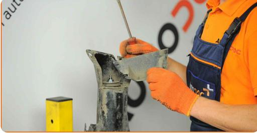
14 Trate la varilla del amortiguador. Use un cepillo de alambre. Use el aerosol WD-40.
