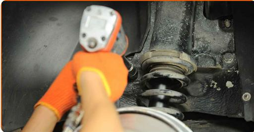
10 Retire la pata amortiguadora.
