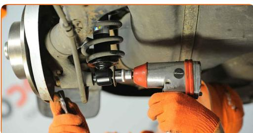
8 Retire el perno de sujeción.
