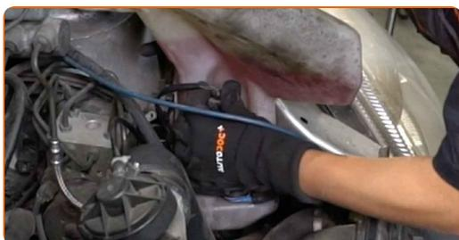
**17** Instale el depósito del limpiaparabrisas.
