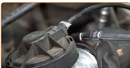
**16** Una el conector de la bomba del limpiaparabrisas.
