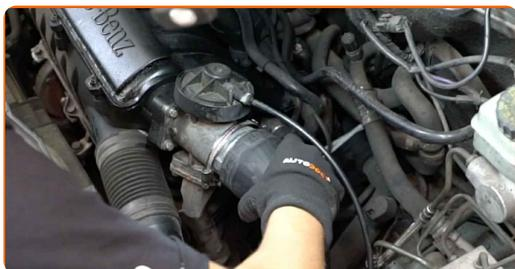
**15** Atornille la abrazadera que conecta la manguera del filtro de aire al cuerpo del acelerador. Use un vaso de impacto del n.º 7. Utilice una llave de trinquete.
