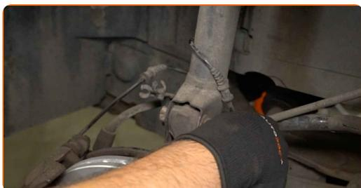
**15** Limpie las sujeciones que conectan el puntal amortiguador a la mangueta de dirección. Use un cepillo de alambre. Use el aerosol WD-40.
