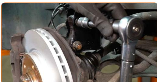
**47** Conecte los cables del captador ABS.
