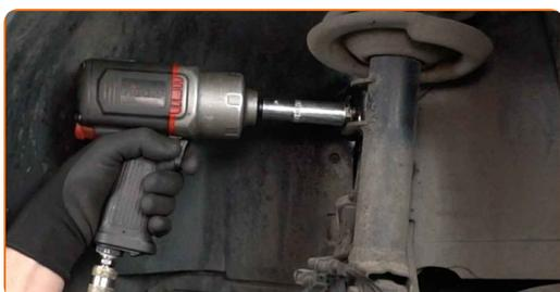
**12** Retire el enlace estabilizador de estabilidad transversal.
