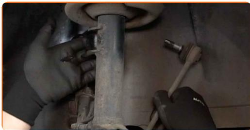
**13** Desconecte el cableado del captador ABS.
