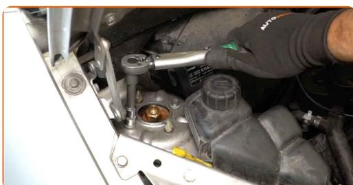
**60** Trate las sujeciones del amortiguador. Use grasa de cobre.
