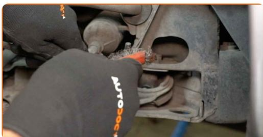
**50** Instale la barra del estabilizador de estabilidad transversal.
