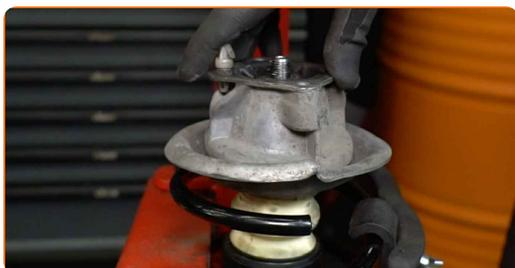
**35** Apriete la tuerca de la varilla de la pata amortiguadora. Use un vaso de impacto del n.º 21. Use Vaso HEX No. H6. Utilice una llave dinamométrica. Apriételo a un par de 60 Nm.
