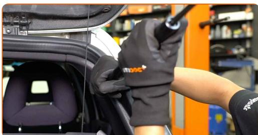
**12** Haga encajar la arandela de ajuste que conecta el amortiguador de gas a la puerta del maletero.
