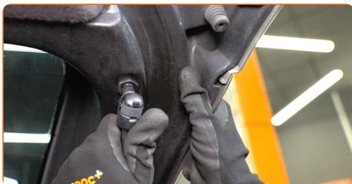
**13** Instale el nuevo amortiguador de gas de la puerta del maletero.
