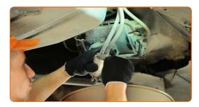
Separe los tubos del filtro de combustible. Utilice un destornillador plano.
