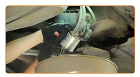
Afloje las abrazaderas de sujeción de los tubos del filtro de combustible. Use un vaso de impacto del n.º 7. Utilice una llave de trinquete.
