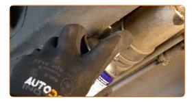
Destornille los bulones de fijación del soporte del filtro de combustible. Use un vaso de impacto del n.º 8. Utilice una llave de trinquete.
