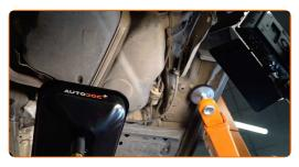
Afloje la abrazadera de sujeción del tubo del filtro de combustible. Use un vaso de impacto del n.º 7. Utilice una llave de trinquete.
