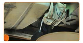
Desconecte el tubo del filtro de combustible. Utilice un destornillador plano.
