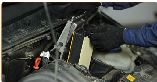
**7** Saque de la carcasa del filtro el elemento filtrante de recambio.
